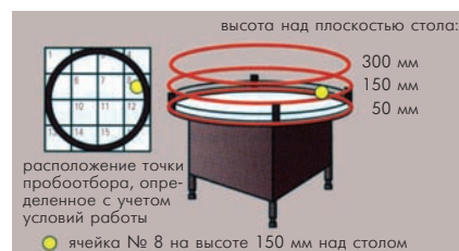
Рис. 4. Рассчитанное положение точки пробоотбора для накопительного стола на выходе из стерилизационного туннеля
