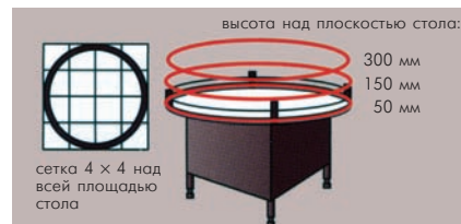
Рис. 2. Сетка, делящая поверхность накопительного стола на выходе из стерилизационного туннеля, для проведения измерений по его квалификации
