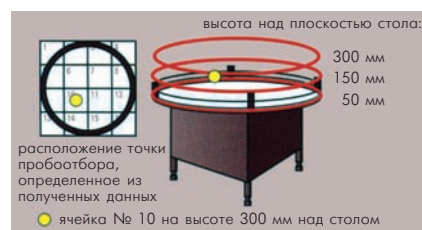
Рис. 3. Точка наибольшего риска для накопительного стола на выходе из стерилизационного туннеля
