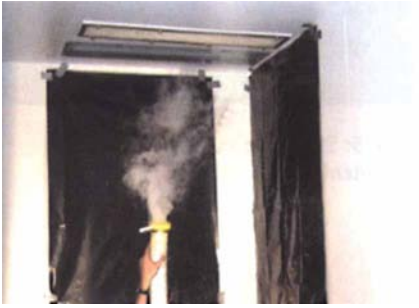
Рис. 5. Поток из помещения к решетке отработанного воздуха на потолке
