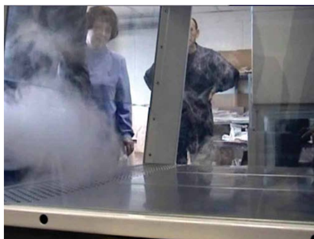
Фото 2. Проверка ламинарного бокса. Воздух извне не попадает в рабочую зону бокса. Снимок любезно предоставлен Миасским заводом медицинского оборудования.
