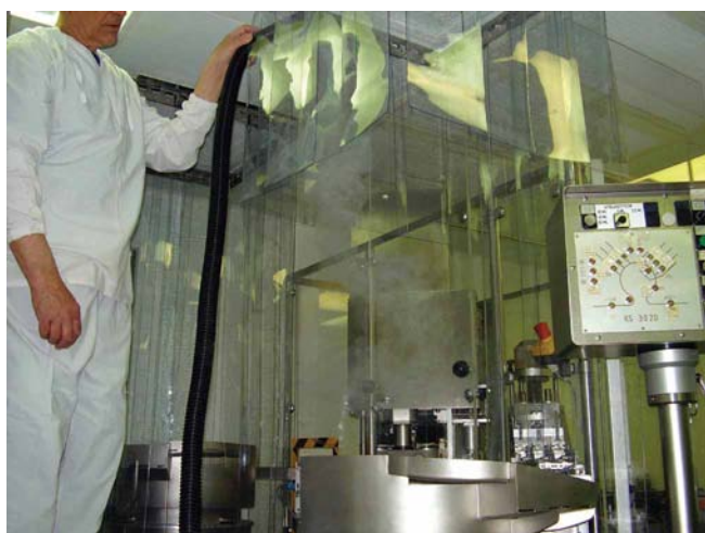
Фото 1. Проверка однонаправленного потока воздуха внутри изолированной прозрачными шторками зоны. Хорошо видно отсутствие перемешивания с наружным воздухом. Снимок любезно предоставлен Миасским заводом медицинского оборудования.
