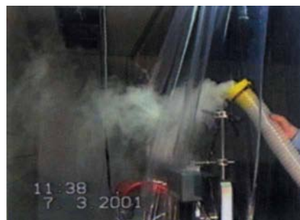
Рис. 3. Воздух проходит через завесу из зоны со слаботурбулентным потоком в турбулентное окружение
