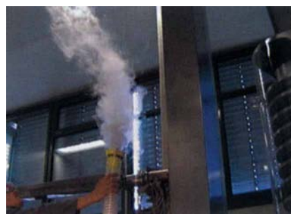
Рис. 4. Поток воздуха в турбулентно вентилируемом помещении
