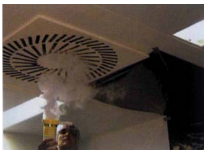
Рис. 1. Зона обратного потока в середине вихревой выпускной решетки
