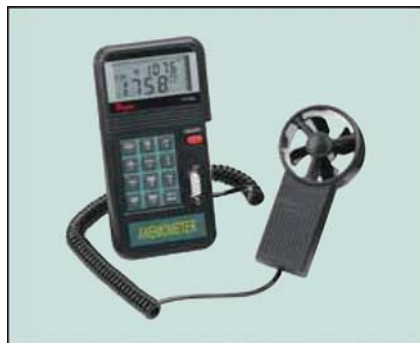
Рис. 4. Крыльчатый анемометр VT-200 фирмы Dwyer (США).
