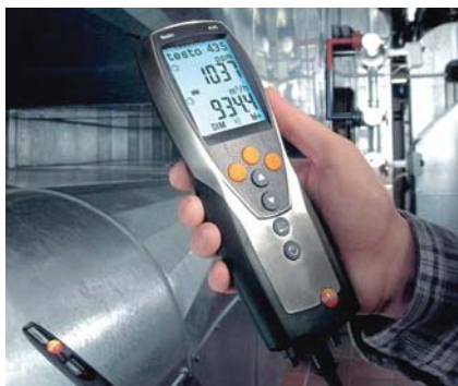
Рис. 2. Многофункциональный измерительный прибор Testo 435.
