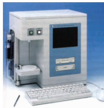
Рис. 2. Внешний вид типичного лабораторного счетчика частиц в воде
